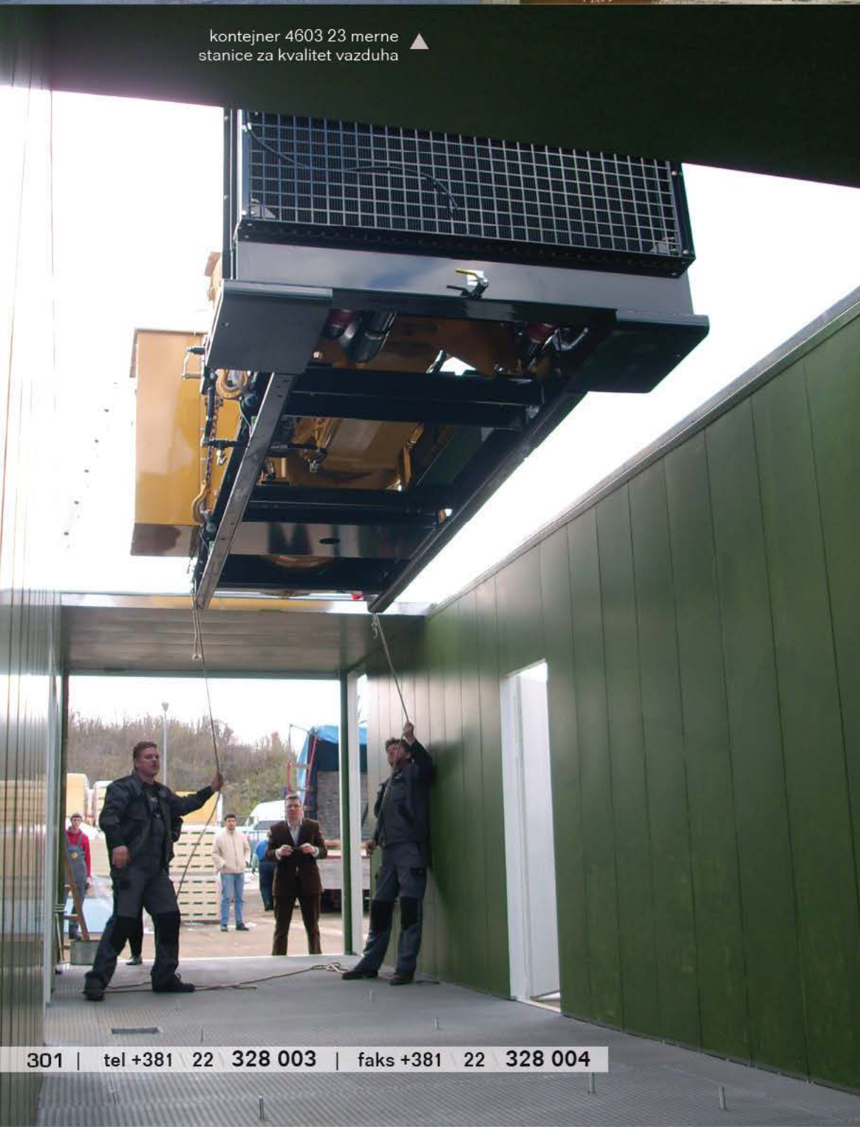
kontejner 4604 20 12,4 x 3,0 visine 3,0 m za smeštaj agregata Caterpillar
