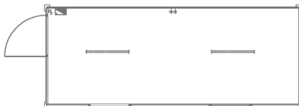
▲ 1102 kancelarijski kontejner 6,0 x 2,4 m 1 vrata, 2 prozora, termoizolovan, razvod struje nazidno PVC kanalicama, osigurači, dve fluo baterije 2 x 36W IP 54, dve monofazne utičnice, pod laminat
